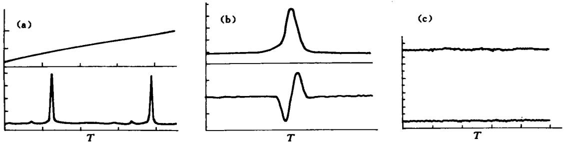
图 2 (a) 倍频腔扫描电压和红外透射曲线; (b) 红外透射曲线及对应的鉴频信号; (c) 锁定倍频腔后的红外透射曲线
