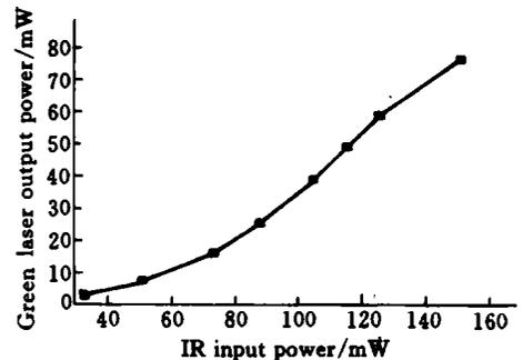
图 4 倍频光输出功率随基频光抽运功率的变化曲线
